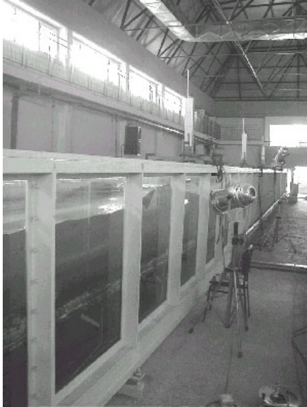
Şekil 1. Hidrolik denemelerde kullanılan tek yönlü dalga kanalında dalga üretimi ve dalga parametrelerini ölçen dalga sensörleri.
