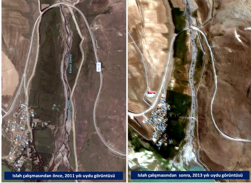
Şekil 3. Kömürçü Deresi'nin ıslah çalışmasından önce ve sonraki görünümü Figure 3. View of after and before from that flood control studies of Kömürçü Stream
