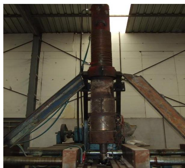
Şekil 2b. Enjeksiyon sistemin hidrolik ünitesi
