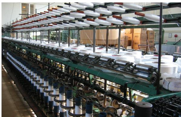
Şekil 5. Tek kat ipliği ağ iplığıne dönüştüren katlama makinesi.
