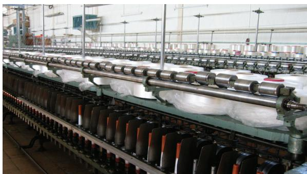
Şekil 4. Elyafin ipliği dönüştürülmesinde kullanılan büküm makinesi.
