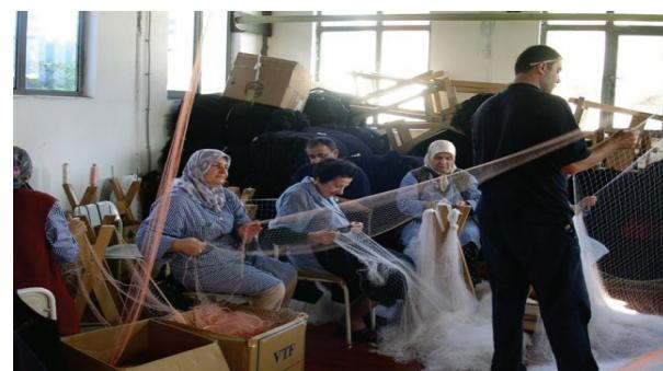
Şekil 8. Üretimden kaynaklanan hataların onarımı (meramet).
