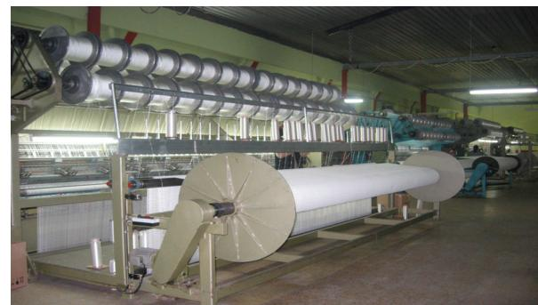
Şekil 7. Düğümsüz ağ dokuyan makine
