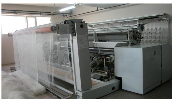
Şekil 6. Düğümlü ağ dokuyan makine
